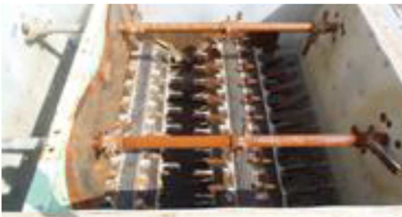
写真 5 2 軸粘性土供給器
