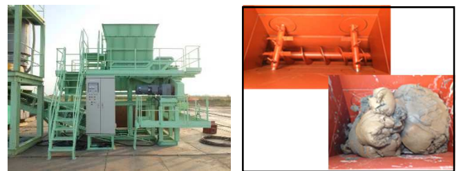
写真1 高粘性・高含水比対応型「一軸粘性土供給機」と供給軸部及び対象粘性土(例)
