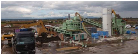
写真3 適用プラント(1軸粘性土供給機)
