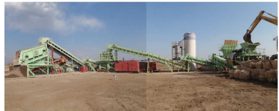
写真4 適用プラント(2軸粘性土供給機)
