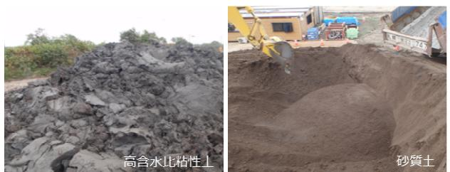
図-6 原土(高含水比粘性土と砂質土)
